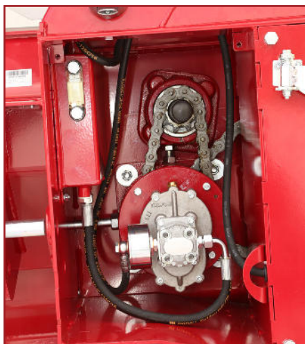
Antrieb der Hydraulikpumpe über Getriebe mit Druckfilter
